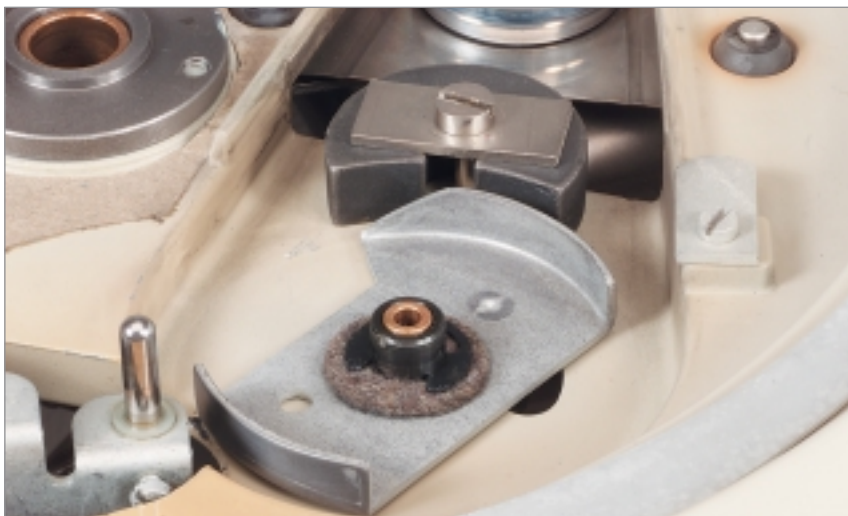
Blick auf die Wirbelstrombremse bei abgenommenem Stufen- und Reibrad (links)
